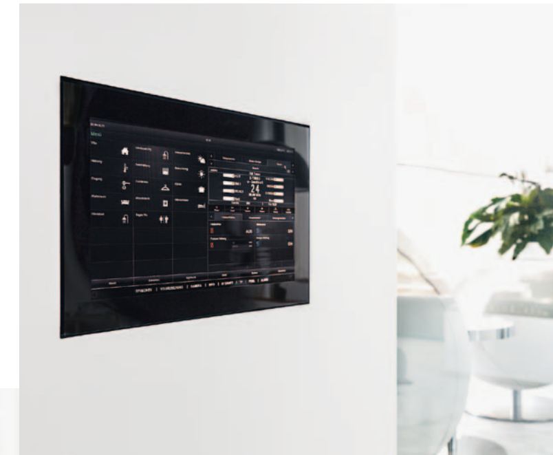
Netzwerk: Sämtliche elektrisch relevanten Komponenten sind vernetzt. Das «Gehirn» dahinter ist ein Gira HomeServer.
